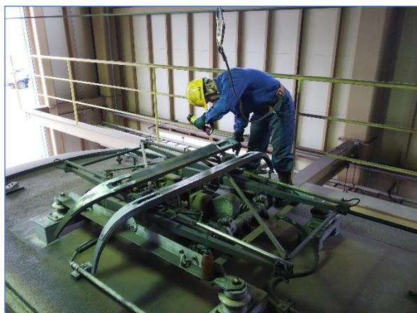
車両総合検査庫において、車両を安全に運転できる状態に保持するよう、法令で定められた検査周期および方法を遵守し、検査の種類に応じて点検・整備を実施し、輸送の安全の確保に努めています。
